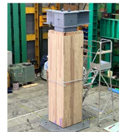
被覆施工完了
